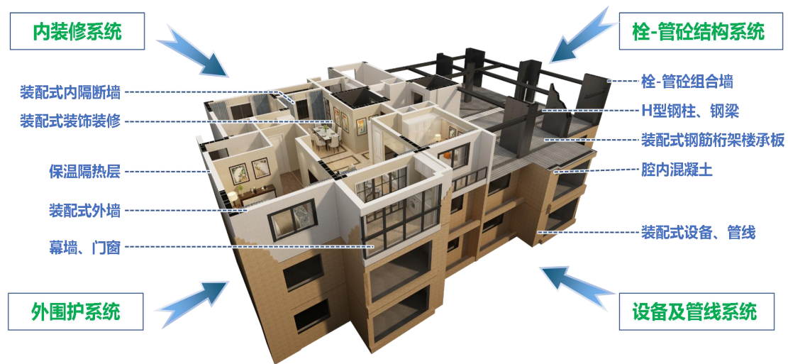
图 A.6.1 对穿螺栓多腔钢管组合墙结构住宅体系示意
