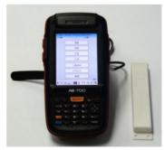
图 5.8 RFID 射频读码器
