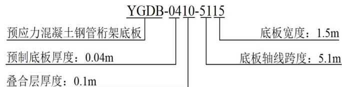
图5.4.3-1 预应力混凝土钢管桁架叠合板编号规则示意图
